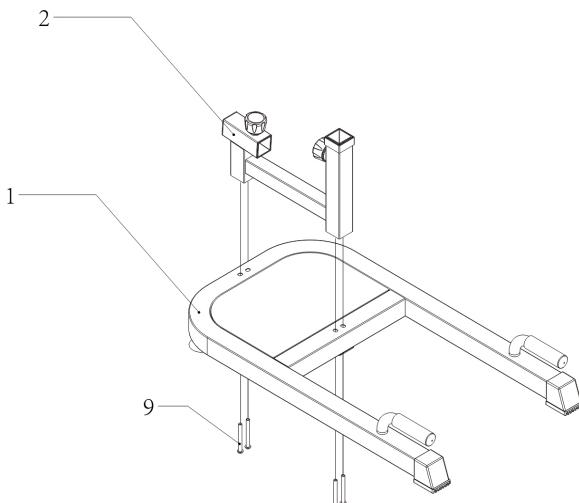
Befestigen Sie die Basis der Stütze und der Beinhalterung (2) mit den Schrauben (9) am Hauptrahmen (1). Ziehen Sie sie mit dem Inbusschlüssel (10) fest an.
