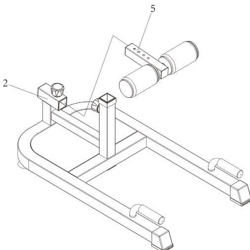
Vložte držiač na nohy (5) do predného profilu základne nosníka a držiaka na nohy (2), potom ho dotiahnite otočným gombíkom.
