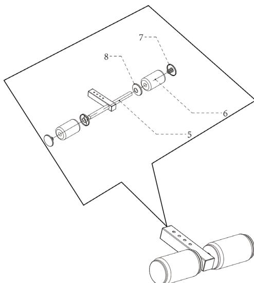
Setzen Sie die Abdeckungen (8) und Rundpolster (6) auf die Querstangen des Fußhalterung (5). Setzen Sie dann die Endkappen (7) wie gezeigt ein.
