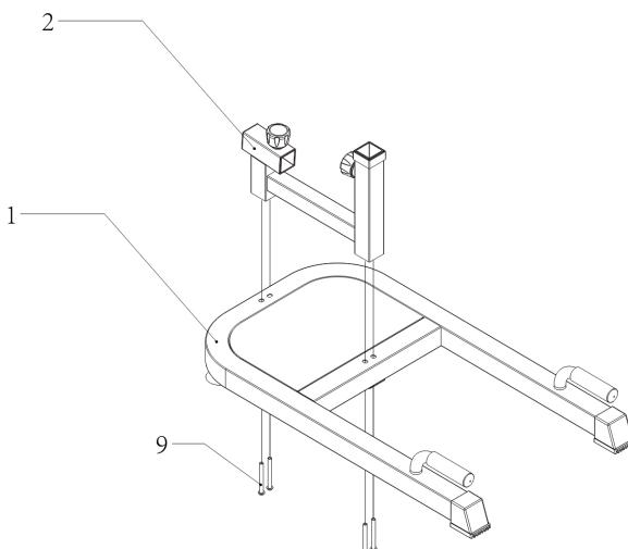
Přišroubujte základnu sloupu a držák nohou (2) k hlavnímu rámu (1) pomocí šroubů (9). Pevně je utáhněte pomocí imbusového klíče (10).
