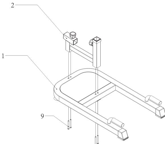
Pripevnite základňu nosníka a držiaka na nohy (2) k hlavnému rámu (1) pomocou skrutiek (9). Utiahnite ich pomocou imbusového klúča (10).
